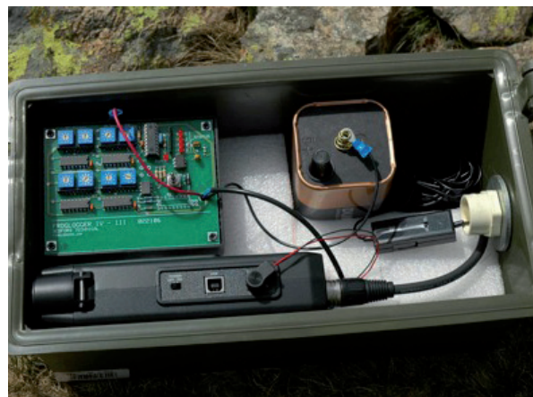
Foto 7. Sistema de grabación de cantos para el seguimiento de machos adultos de Alytes obstetricans . Autor: Jaime Bosch
