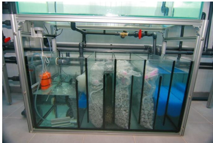
Figura 18: Filtre de dues bateries.
