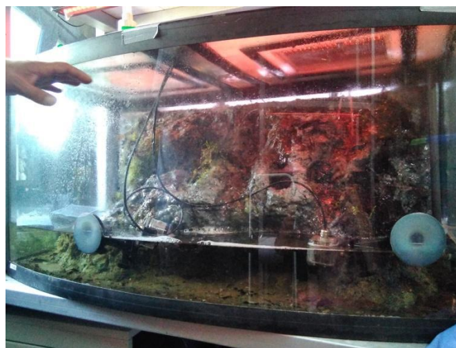
Figura 17: Aquari simulador dels torrents del Montseny.
