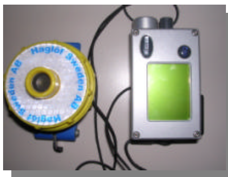
Figura 3.2. Vèrtex utilitzat per mesurar distàncies i alçades.
